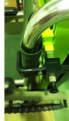
⑦フレームが溝の位置にきたら赤い→方向に左右共押ししてレバーでしっかりと
