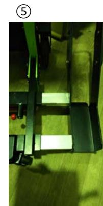
④車輪幅を合わせます。赤いノブを引き上に回します。⑤車輪幅に合わせたら必ず赤いノブは横にし
