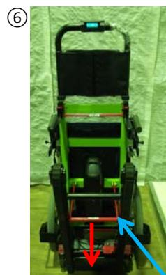
④車椅子を降ろします。⑤赤いパイプを前に押して昇降レバーを下に ⑥赤いパイプを下へ押しベルトを畳む
